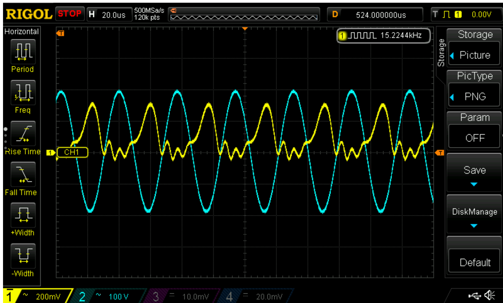
Рис. 10 Осциллограмма пульсаций пузыря (канал 1 – фотодетектор, канал 2 – пьезоэлектрические преобразователи)
