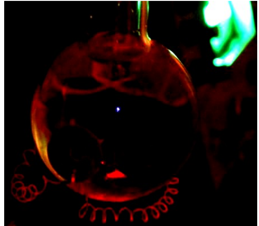
Рис. 3 Однопузырьковая сонолюминесценция в сферической акустической камере, полученная мною в 2018 г. (выдержка 30 с, ISO3200)
