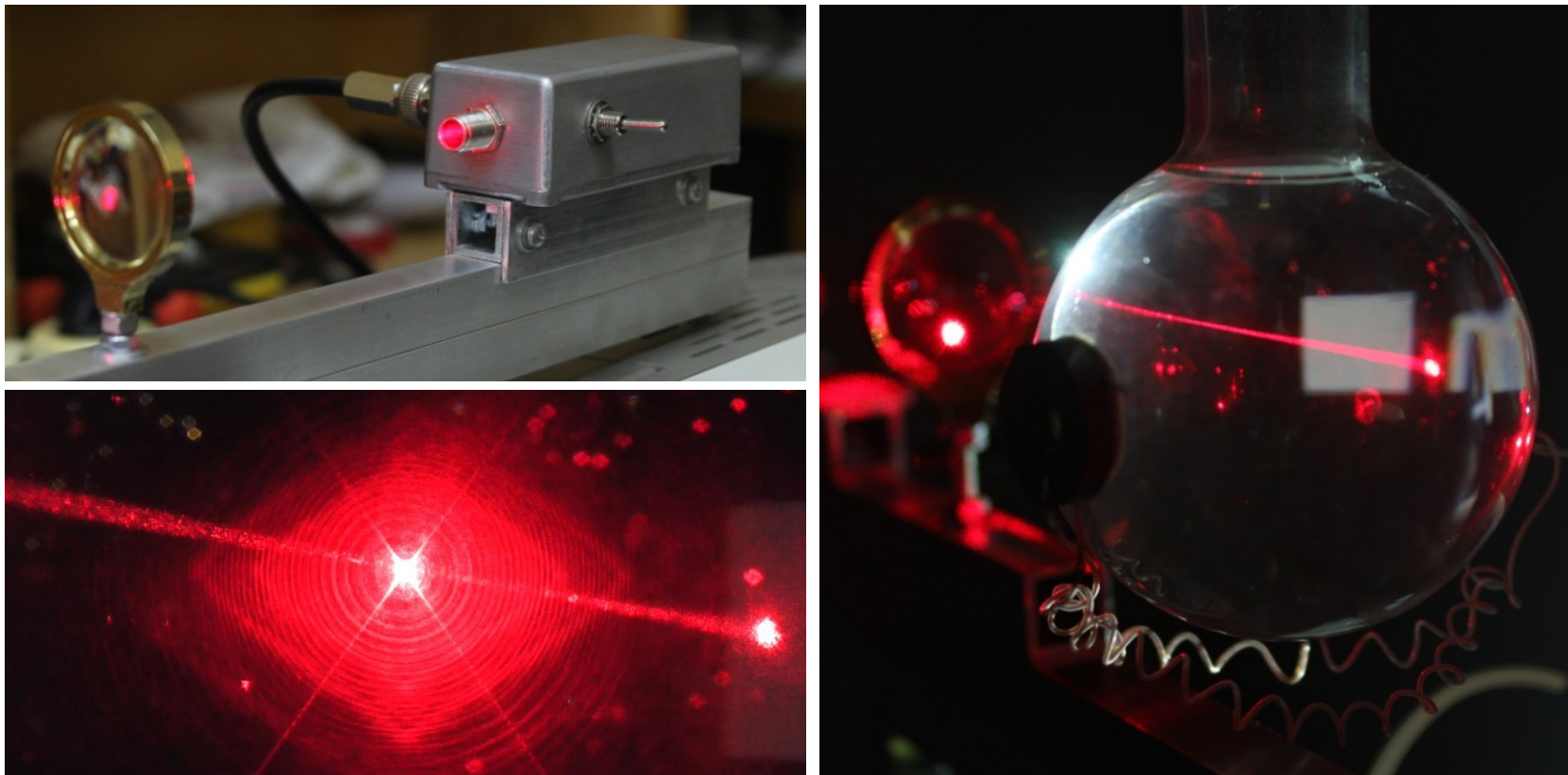
Рис. 9 Лазерный луч попадает в фотодетектор, проходя через колбу с водой и пульсирующий кавитационный пузырь
